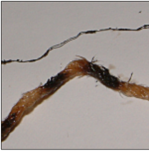
BT-V1 Wicklung zerlegt nach 27.6 ml
