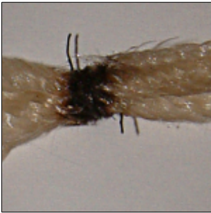
Patriot Mega Wicklung demontiert nach 27 ml
