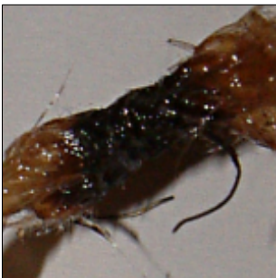
BT-V1 Wicklung demontiert nach 27.6 ml
